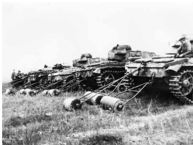
Kontrolkørsel med tyske kampvogne. Rydningen foregik ved, at køretøjerne kørte ind i minefeltet først med det højre bælte, mens det venstre var i minefrit terræn. Kampvognene trak nu tre svære ståltromler (fremstillet på Varde Stålværk), og disse detonerede nu de miner, der befandt sig i området mellem de to bælter. Foto: Blaavandshuk Lokalhistoriske Arkiv.
